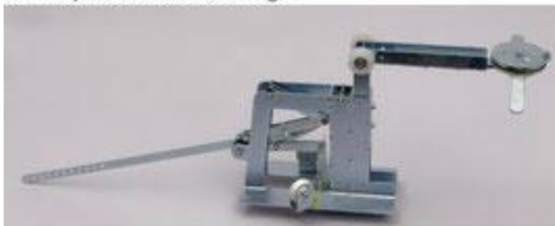
Lenkerposition durch vorziehen des Lenkers an Führungsdraht-Lenkerlagerung ebenfalls mit Lenkerplatte. Lenker und Vorderachse gerade stellen und Lenker mit der Schraube sichern.
